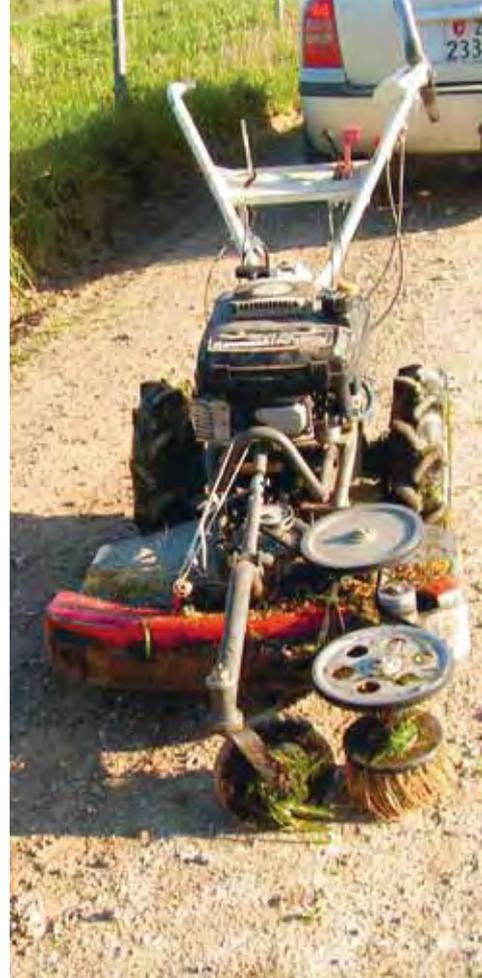
Marke Eigenbau: Mit dieser «Wischmaschine» halten Spaltensteins das Bändchengewebe in den Reihen sauber.
