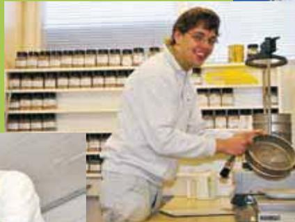
Futter Endkontrolle mittels Siebanalyse
