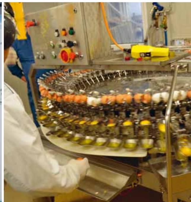
Die Industrieier werden automatisch aufgeschlagen und getrennt. So entsteht Flüssigei für die Lebensmittelverarbeitung.
