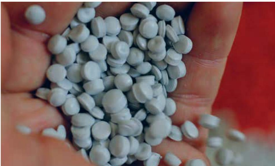
Aus Silofolien wird PE-Granulat.
