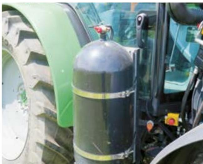
Acht Druckspeicherflaschen mit einem Gesamtvolumen von 316 Liter sind am auf Gas umgerüsteten Deutz-Fahr 5120 C angebracht. Bilder: ks
