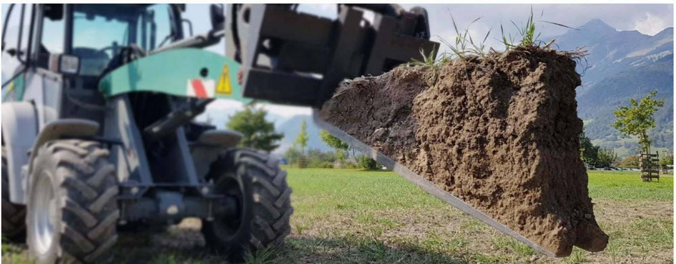
Die Probeentnahme mit der Palettengabel ermöglicht einen tiefen Einblick in den Boden. Bild: Tim Schmid
