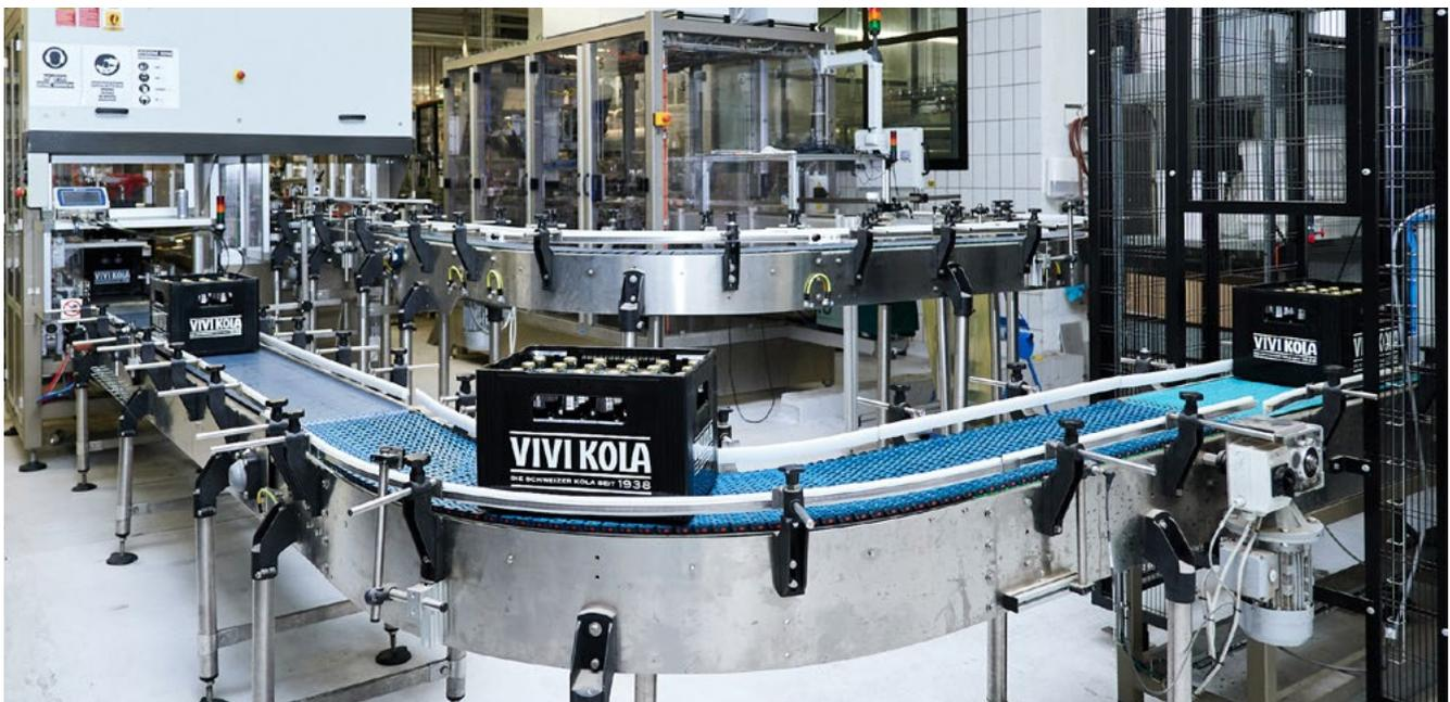
Bis zu 5000 Flaschen pro Stunde sowie PET-Gebinde und Aludosen laufen übers Band der neuen Abfüllanlage in Eglisau ZH. Bild: Vivi Kola
