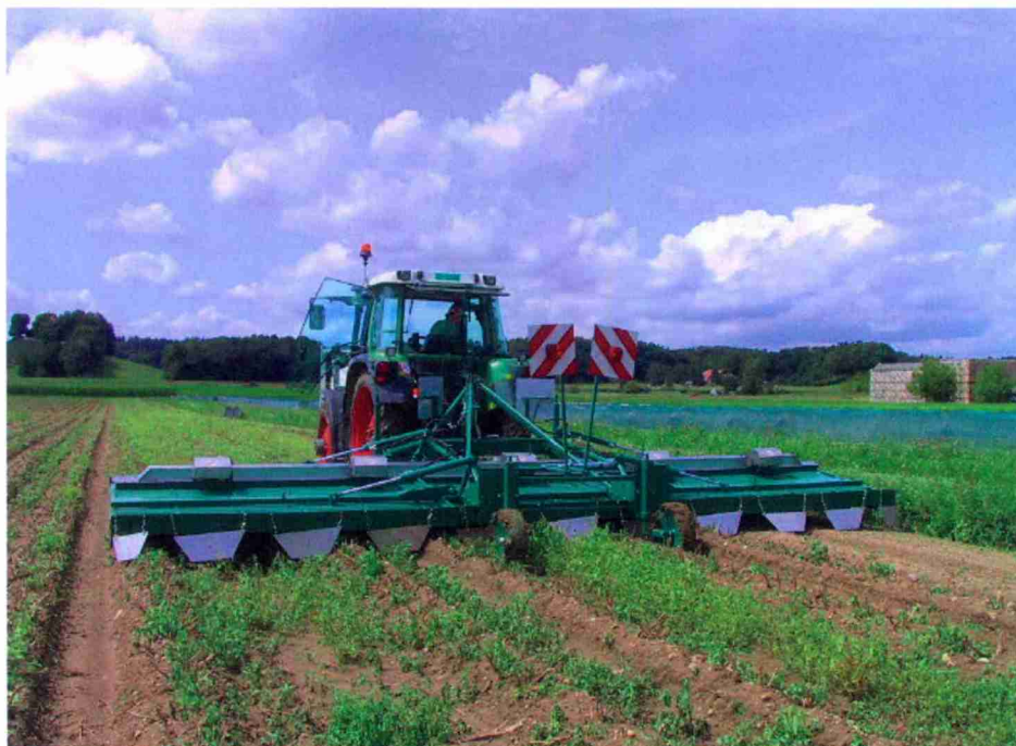
Abflammen von Kartoffelstauden (Modell STffFG7.5LG, Schaffner Terra-Tech AG, Oensingen, 7,5 m Arbeitsbreite, Gasverbrauch 100 kg/h, Geschwindigkeit 2–5 km/h, Gewicht 1400 kg). (Bild zVg)
