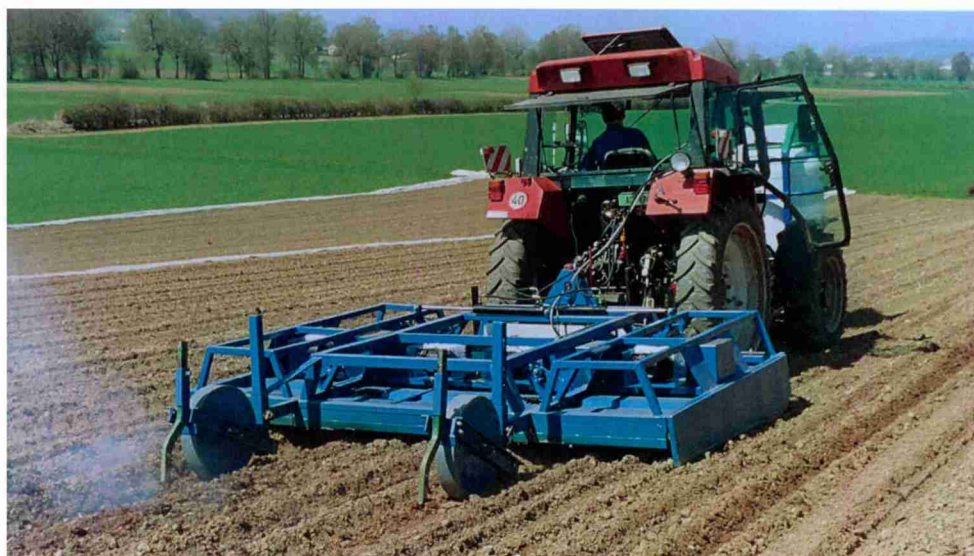
Im Gemüsebau ist das ganzflächige Abflammen im Voraufbau besonders bei Karotten weit verbreitet. Das Abflammgerät StiffG1.5/3.0SG (Schaffner Terra Tech AG, Oensingen) hat mit den beiden hydraulisch klappbaren Seitenteilen von je 0,75 m eine Arbeitsbreite von 3 m. (Foto: zVg)
