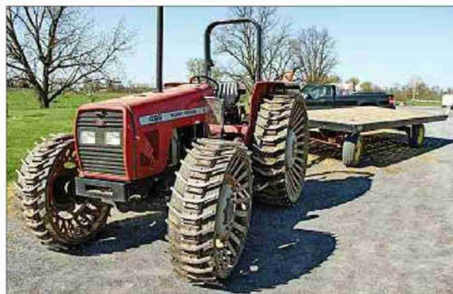
Eisenrad-Traktoren sind gestattet. Denn der Erdkontakt darf nicht durch Luftpneus unterbrochen werden.
