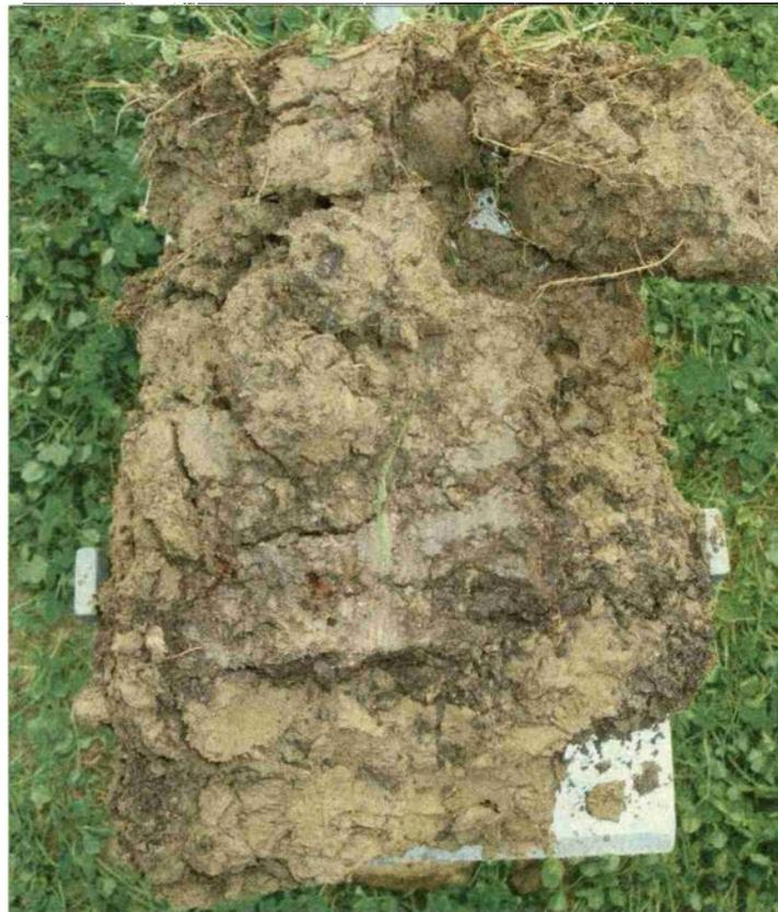
**Mit der Spatenprobe werden Pflugsohlen, Wurzelverkrümmungen und Sauerstoffmangel sichtbar. (Bilder: gro)**
