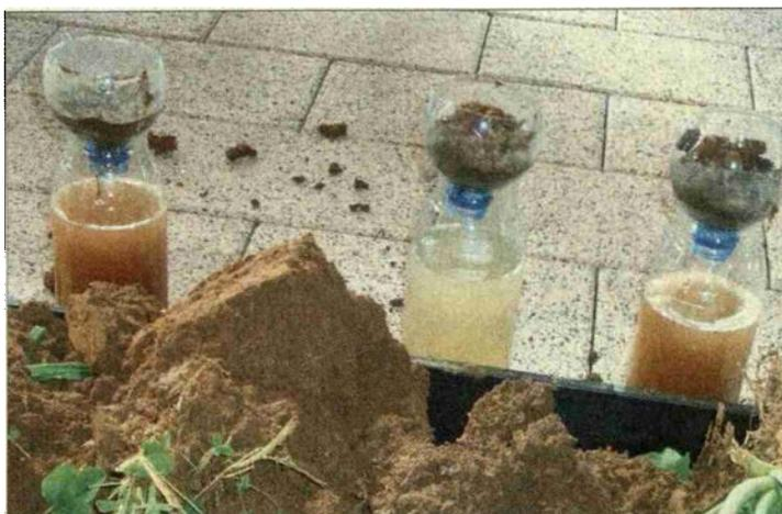
**PET-Flaschen-Test zur Untersuchung der Krümelstabilität. Der Boden in der mittleren Flasche weist die beste Krümelstruktur auf. Da wenig Bodenteilchen mit dem Wasser ausgeschwemmt wurden, bleibt das Wasser klarer.**
