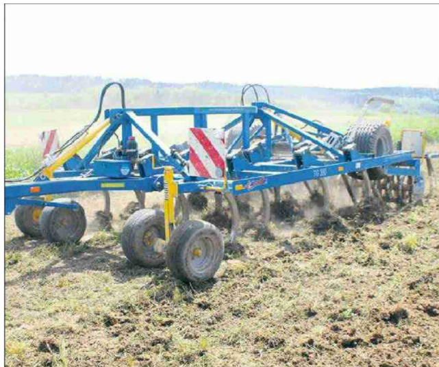
Der gezogene Flachgrubber Treffler reisst die Wiesennarbe sehr gut auf und sorgt damit für eine Art Schockwirkung bei den Pflanzen.
