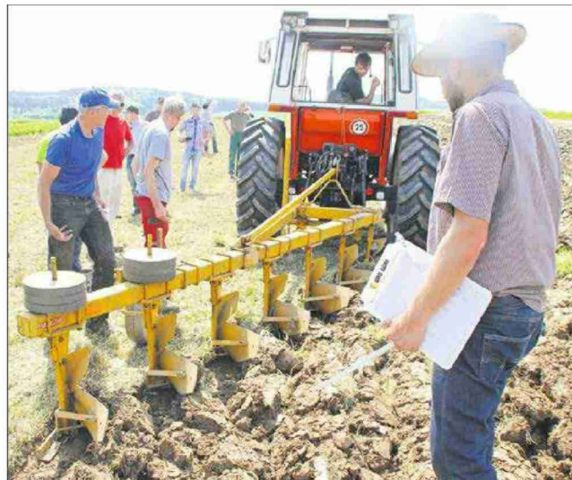
Werner Siegrist setzt diesen Beet-Schälplug zum Wiesenumbruch ein. Er ermöglicht einen Umbruchtiefe von 10 bis 15 Zentimeter. (Bilder RoMu)
