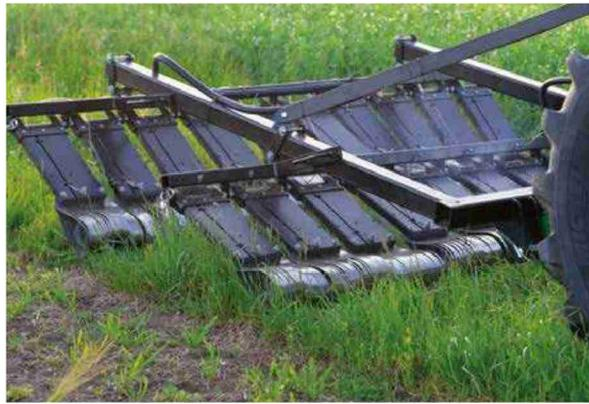
Metallstreifen gleiten über die Pflanzen und übertragen den Strom.
