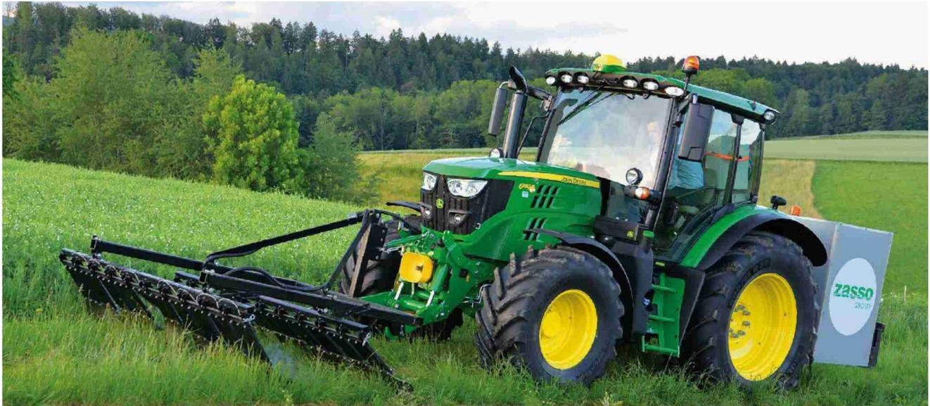
An der Front sind Applikatoren für die Bestromung des Pflanzenbestands montiert. Im Heckanbau wird der 80 kW-Generator mit der Zapfwelle angetrieben. Ein Kabel bringt den Strom an das Frontgerät.
