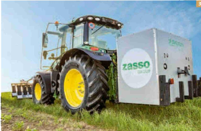
**3 - Der Generator wird durch die Zapfwelle des Traktors angetrieben.**
