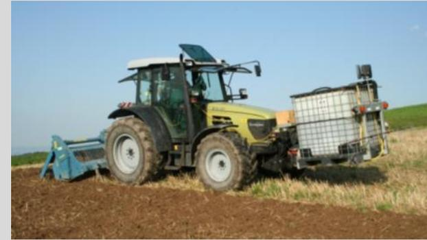
Spatenmaschine mit Bodenimpfung
