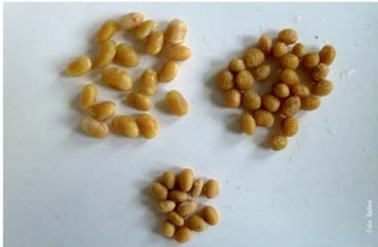
Abb. 4: Bohnen mit relevanten Schäden in der Hülle (oben links) lassen sich nach 10 Minuten im Wasser eindeutig von unversehrten (unten) oder geringfügig beschädigten (oben rechts) unterscheiden.
