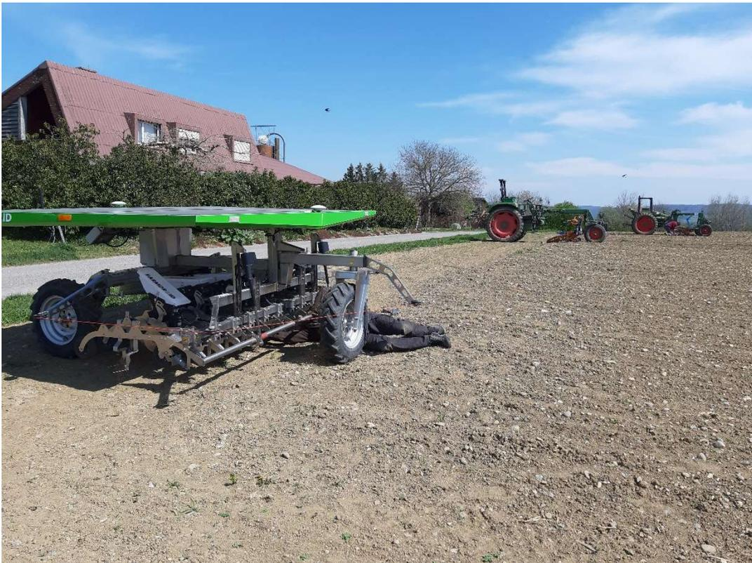
In Rheinklingen werden verschiedene Anbauverfahren für Zuckerrüben in einem Feldversuch getestet. Das betriebsübliche System misst sich mit dem Roboter Farmdroid, sowie dem Anbau von Zuckerrüben auf Dämmen.
