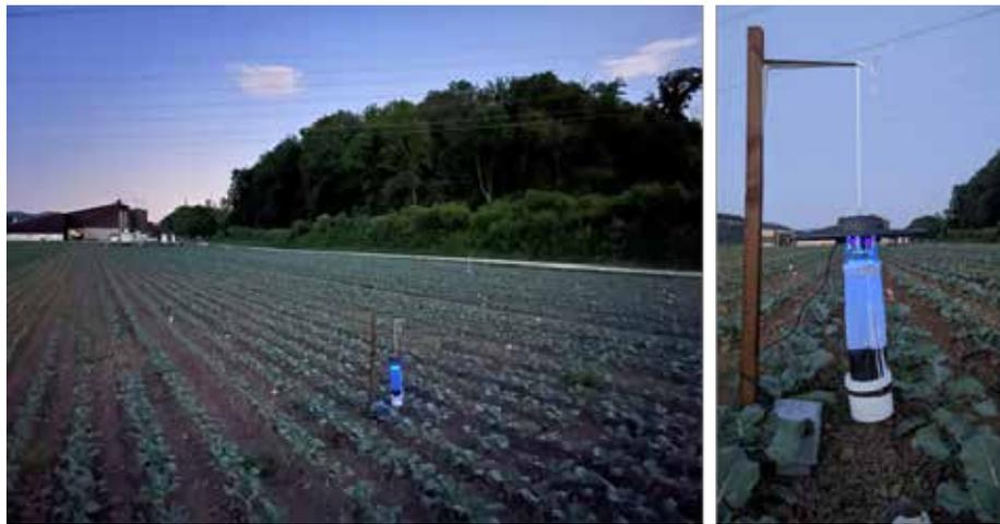
**Bild 3: UV-Licht-Fallen auf dem Feld. Detail der Falle mit dem Netzsystem für die Sammlung von Insekten**
