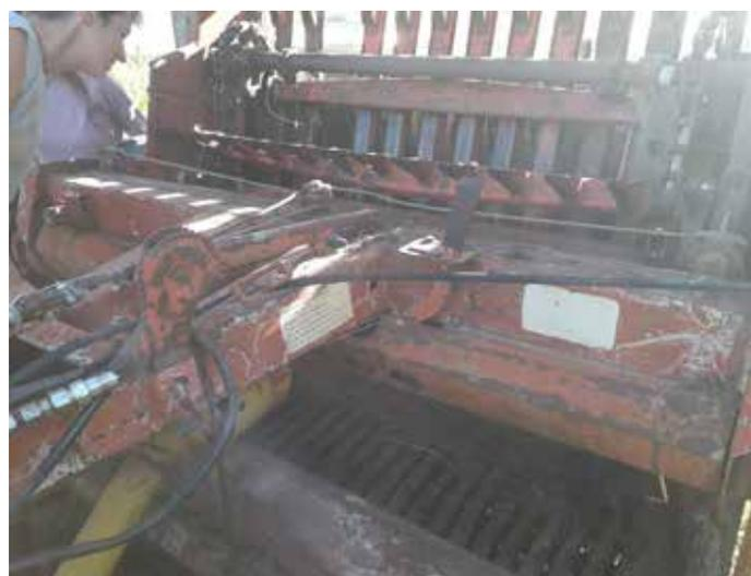
Bild 5: Doppelmesserwerk mit Schnittbreite von ca. 11 cm
