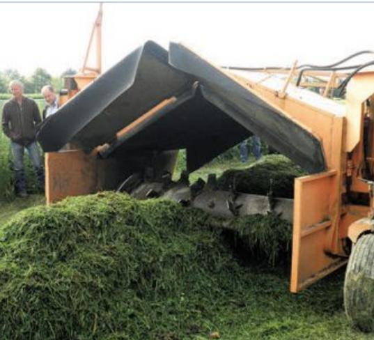
Der Kompostwender im Einsatz; während des Umsetzens kann über das Gerät Wasser beigegeben werden.
