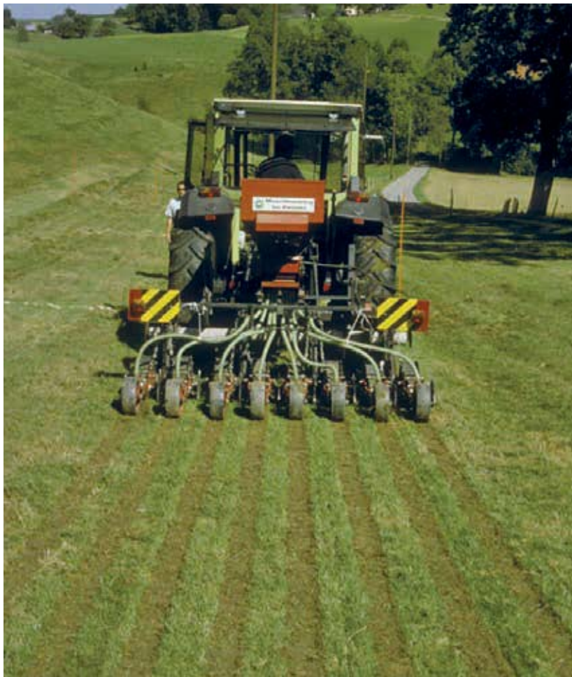
Der Vakutec Slotter fräst den Wiesenbestand auf und legt das Saatgut über ein pneumatisches Sägerät ab. Pneuwalzen drücken den Frässtreifen mit dem Saatgut an.
