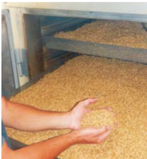
Das Grünmalz wird in einem Darrofen getrocknet.
