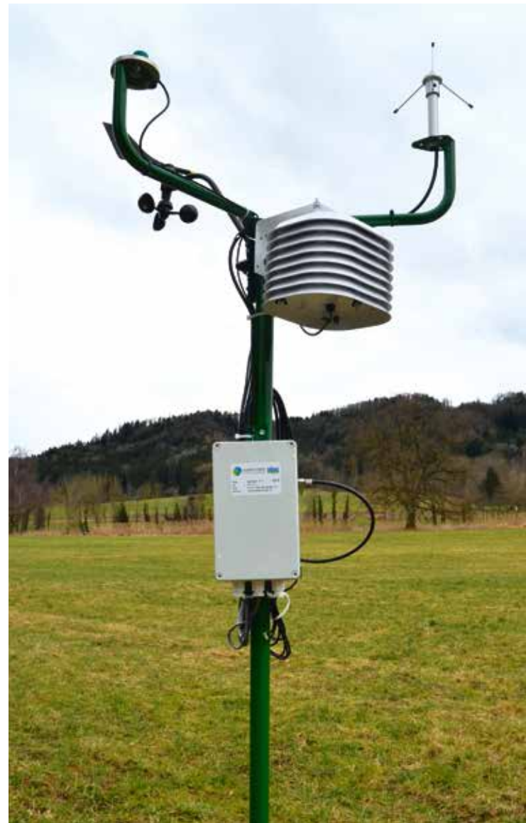
Wetterstation für betriebseigenes Prognosesystem. Bild: Agroscope
