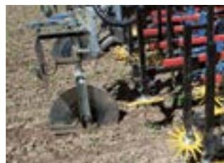
Steuerung der Lenkung mit Scheiben über Satelliten, keine Wirkung in der Reihe, (teil-) autonome Steuerung, Genauigkeit von +/- 2 cm. Hohe Schlagkraft. Preis: Fr. 15 000.-
