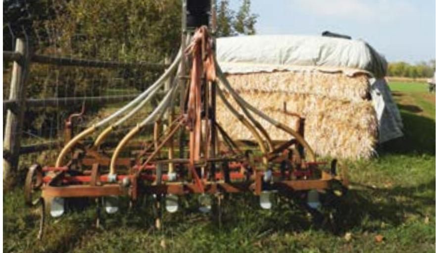
Jean-Pierre Jaussi ist ein Verfechter der Direktsaat, für ihn ist die Bedeutung der Bodenfruchtbarkeit zentral. Er strebt eine minimale Bodenbearbeitung an und hat dazu verschiedene Sämaschinen entwickelt, etwa diese schlagkräftige Kombination: Eine pneumatische Sämaschine im Frontanbau und im Heckanbau ein mit Prallblechen (Saatgutverteilung) ausgerüsteter Treffler-Grubber. *Bilder: Christian Hirschi*
