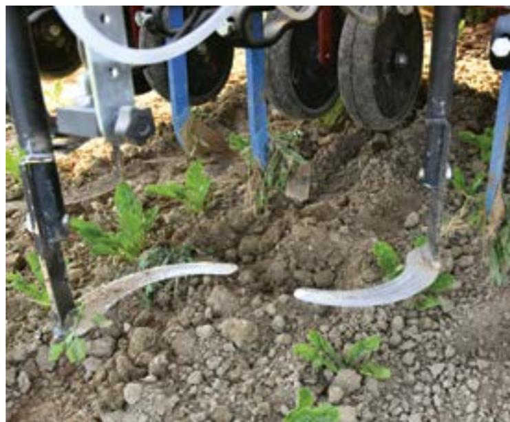
Die neuen kameragesteuerten Hackgeräte sollten das Unkraut auch in der Linie entfernen. Bild: Hansueli Dierauer
