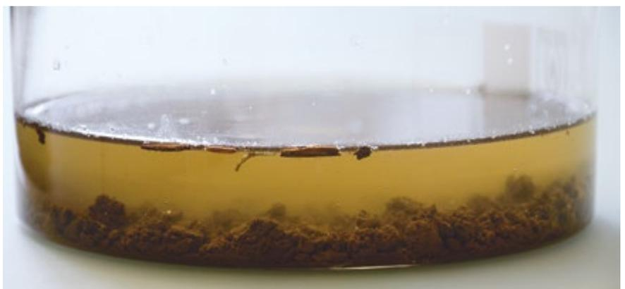
Um den Gehalt der labilen organischen Substanz im Boden zu bestimmen, wird diese mittels Dichtefraktionierung von den mineralischen Bestandteilen getrennt. *Bild: Marius Mayer*
