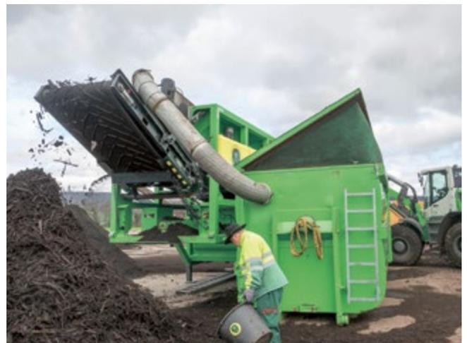
Der Windabscheider entfernt Plastikteile, die noch im Kompost verblieben sind, und sammelt sie in einem Container.
