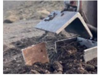
Ein speziell entwickeltes Streifendampfgerät für den Gemüsebau damit die Biodiversität nicht zerstört wird. Dampfschlitten 6 cm tief und 10 cm breit für eine 99,9% Sterilisation des Bodens mit Dampf ohne Chemie. 100% Swissquality.
