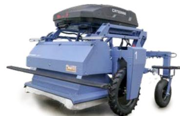
Die Laservorrichtung ist anpassbar für Dämme oder, wie hier, für Beete.
