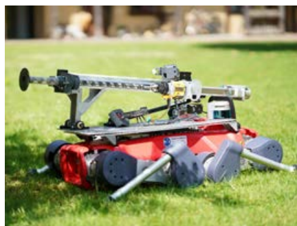
Der Quadruped Robot kann vor Ort Bodenproben entnehmen und analysieren.
