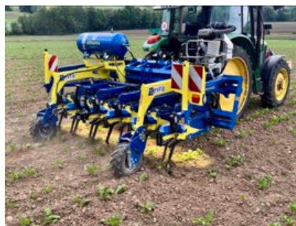
In-Row-Hackgeräte ersetzen Handarbeit bei der Beikrautregulierung in Kulturreihen.
