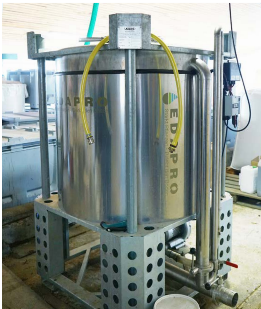
In einem 1000-Liter-Tank wird der Komposttee 36 Stunden lang bei 24 Grad gebraut.
