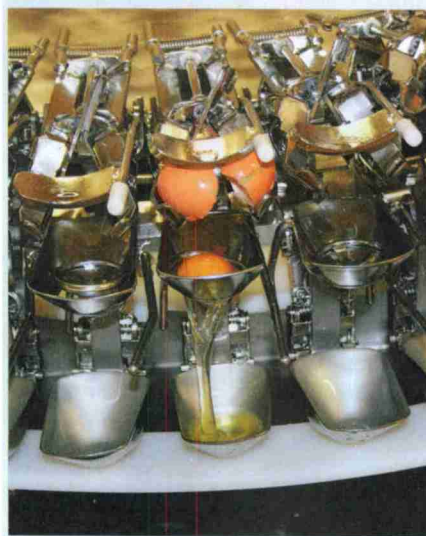
Eieraufschlagmaschine bei der Firma Hosberg AG in Rüti. • Machine à casser les œufs de l'entreprise Hosberg AG, Rüti.
