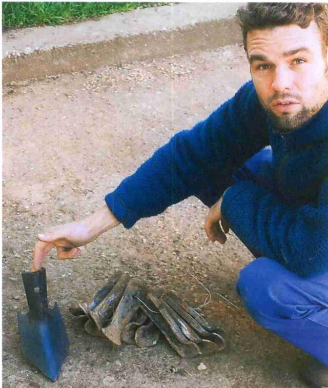
Je nach Bedürfnissen des Bodens werden unterschiedlich breite Scharen verwendet. Der Austausch am Gerät dauert nur wenige Minuten.
