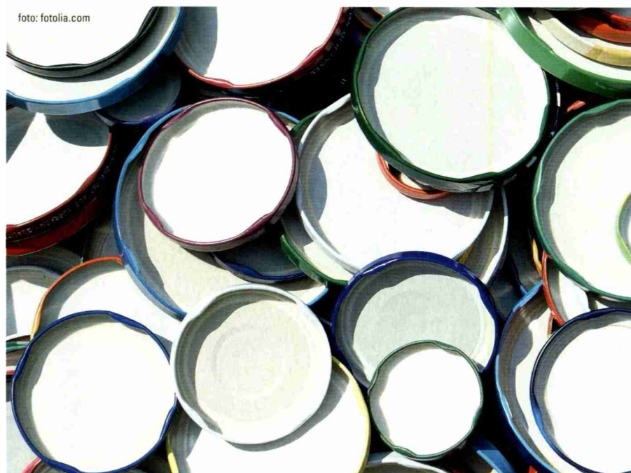
Abbildung 1: Schraubdeckel mit weichmacherhaltigem Dichtungsring.
