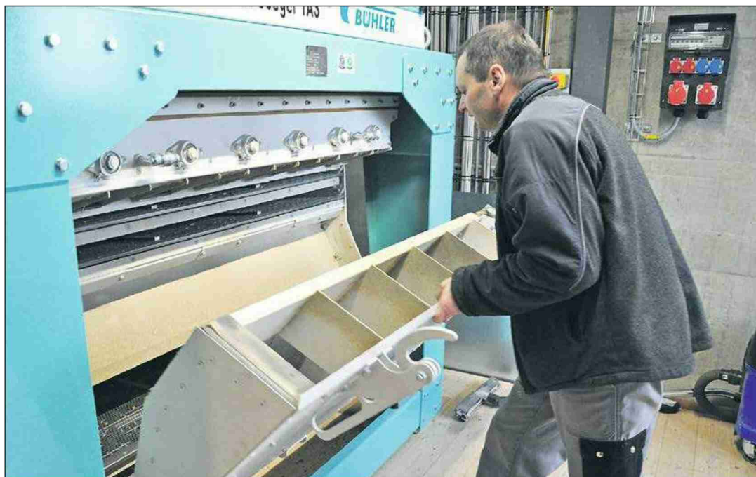
Aus einer üblichen Getreidereinigungsmaschine haben Urs Rubin und die Firma Bühler eine Sortiermaschine gemacht. Das Ergebnis übernimmt die gewünschte Aufgabe souverän.
