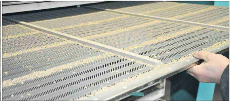
Eine Probe der Erbsen-Gerste-Mischung nach dem Reinigungsdurchgang. Das Sieb mit den diagonalen Schlitzen ist für die Grösse der Gerste konzipiert. (Bilder Nadine Baumgartner)
