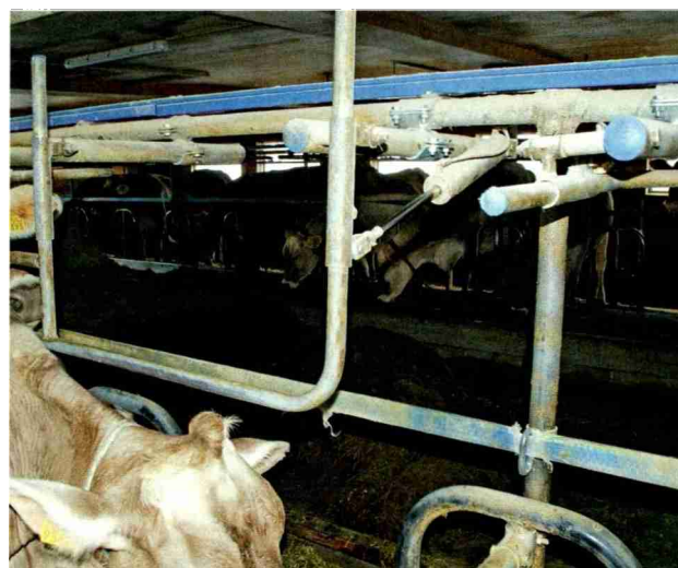
Der pneumatische Zylinder hat ein Signal erhalten, der Bügel wird nach unten gedrückt und die Kuh muss zurücktreten.
