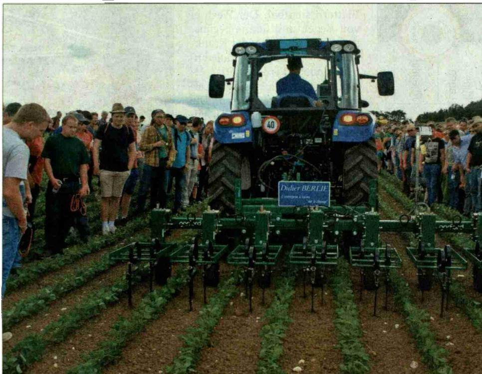
An der Maschinendemo machten sich die Besucher ein Bild über die Arbeitsweise verschiedener Hackgeräte und Grubber. Das kameragesteuerte Garford-Hackgerät (Bild) leistete auch im harten Boden gute Arbeit. (Bilder: Doris Grossenbacher)
