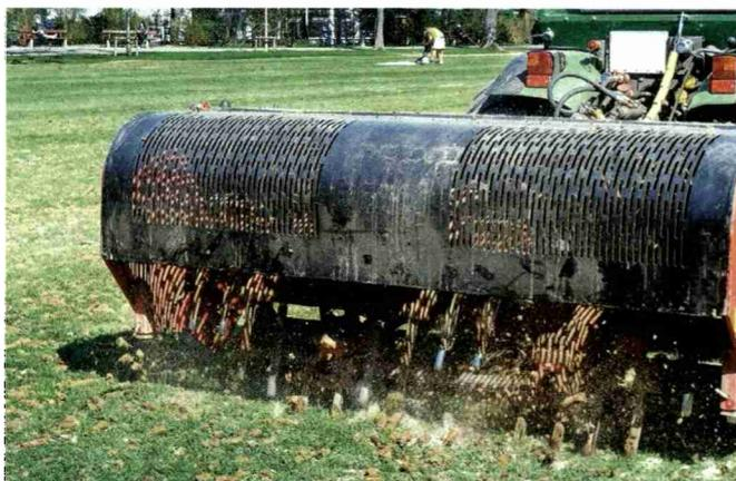
Durch die mechanische Bearbeitung werden die Böden gelockert und belüftet.
