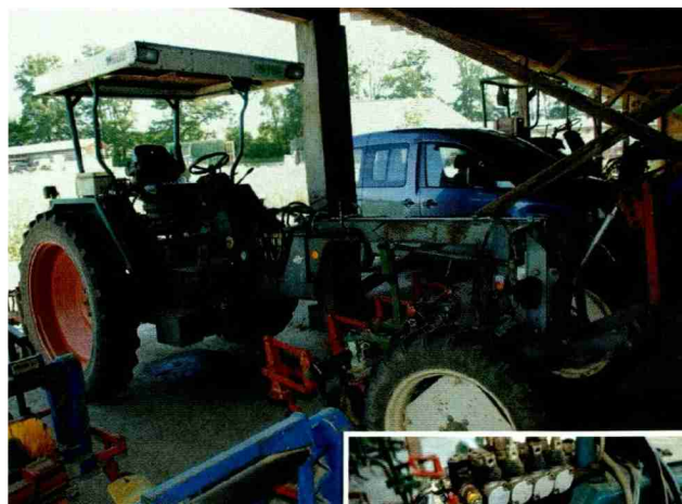
Extrem wendig: knickgelenkter Fendt-Geräteträger mit selbst aufgebautem Joystick für die Steuerung von 8 hydraulischen Funktionen.
