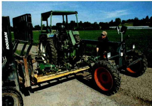
Dadurch, dass der Längsholm am Fendt-Geräteträger hoch angesetzt ist, können die verschiedensten Striegel und Hackgeräte unten angebaut werden.
