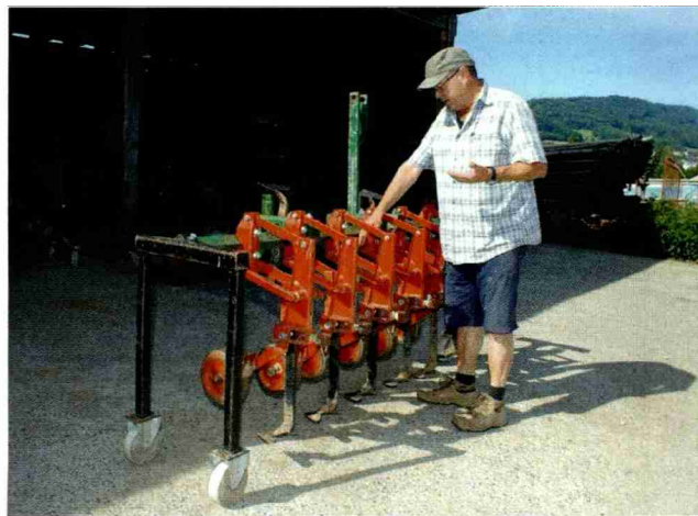
Stephan Müller schätzt an den Haruwy-Hackgeräten die sehr schlanken und hochgebauten Hackkörper. «Mit diesen hat der Fahrer jederzeit beste Übersicht und man kann sie auch in hohen Gemüsen einsetzen.»
