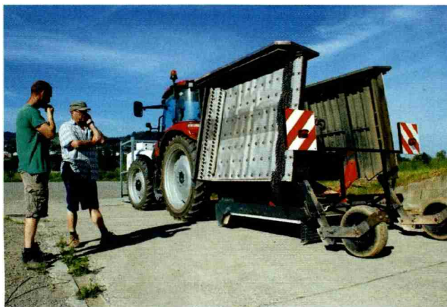
Neues leistungsstarkes 4,5-m-Abflamngerät von Hersteller Hoaf. «Mit diesem haben wir mehr Leistung und einen geringeren Gasverbrauch als mit dem bisherigen», sagt Martin Müller.
