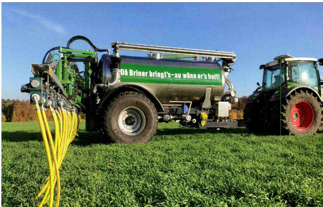
Die Peter Briner AG hat mit Partnern ein Fass gebaut hat, das eigens zur Ausbringung des Bio-Flüssigdüngers konzipiert ist. Bild: zVg
