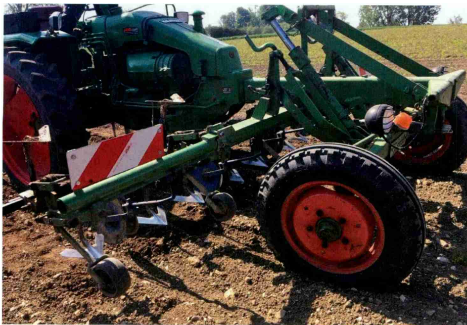
Herkömmliche Hacktechnik mit leichtem Gerät. Einsatz in auflaufendem Mais anlässlich des Arenenberger Ackerbautreffs. Auf dem Bild sind die Hackkörper angehoben. (Foto: Philipp Trautzi)
