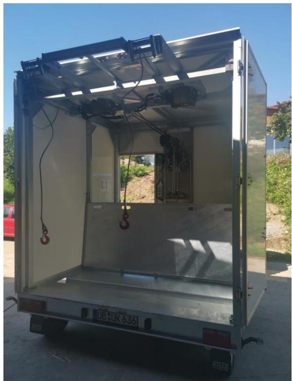
Die Kranschiene ist an der Decke montiert und lässt sich ausfahren. Zwei unabhängig funktionierende Seilwinden ziehen das Tier an den Beinen hoch. Danach wird die Kranschiene eingefahren, die Türen verschlossen und das Tier im geschlossenen Raum sauber, hygienisch und anonym ausgeblutet. Die Box lässt sich einfach reinigen und ist schnell wieder einsatzbereit.
