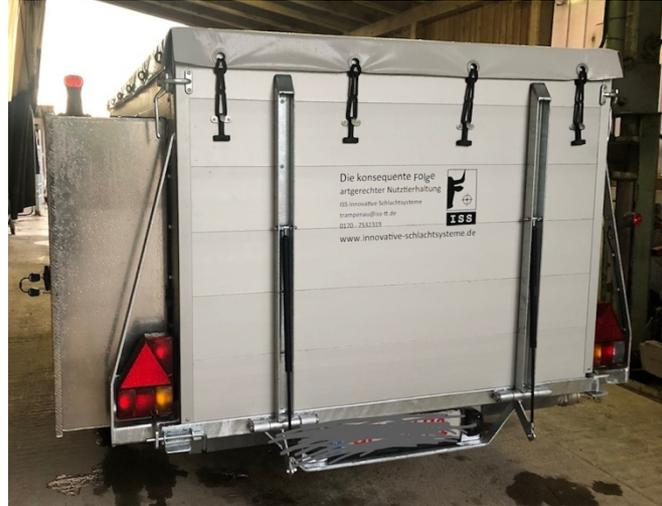
Die Bordwände sind aus 25 mm eloxiertem Alu-Hohlkammerprofil. Der Boden besteht aus 5 mm Aluriffelblech. Hinten im Anhänger ist eine groß dimensionierte Blutauffangwanne komplett mit dem Rahmen verschweißt und mit einem verschließbaren Ablaufhahn versehen.
