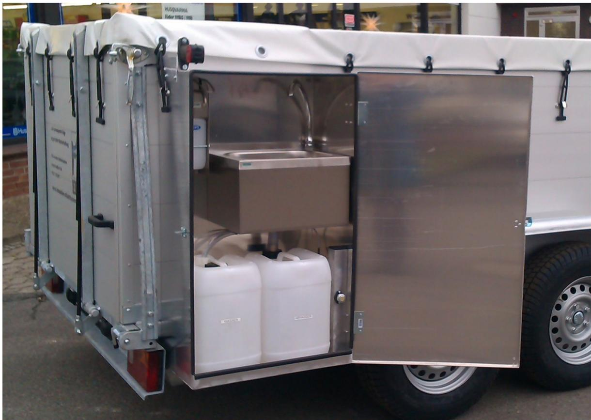
Außen am T-Trailer ist die Hygieneeinrichtung montiert. Waschbecken mit Seifenspender und Desinfektion sowie der Frischwasser- und Schmutzwasserbehälter befinden sich in einer geschlossenen Einheit. Der Wasserbehälter ist mit einer Tauchpumpe ausgestattet.
