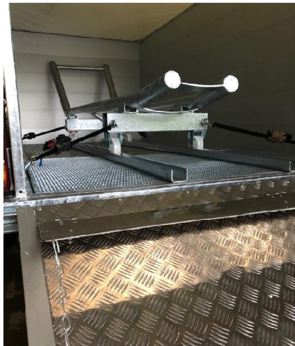
Der Schragen ist aus Stahlprofilen gefertigt feuerverzinkt und mit 4 Stück verschraubten Kunststoff-Schwerlastrollen ausgestattet. Der T-Trailer kann je nach Bedarf mit einem oder mit zwei Schragen bestellt werden.
